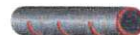
CANALISATIONS BICÔNES Ø150mm AVEC OUVERTURES Ø10mm OU FENTES DE 5mm MINIMUM ESPACÉES TOUTS LES 10 À 15cm
